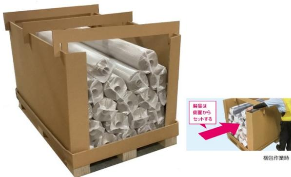
自動車シート用原反ロール(長さ 1700×直径 300mm)の包装で、従来ワンウェイ・スチールラック(内寸 2200×1110×1010 mm)に収納していたが、デットスペースが大きくコンテナ積載効率に無駄が生じていた。また荷詰めの際、支柱で怪我の恐れがあり、安全面を最優先とした改善が求められた。そこで積載効率と作業効率向上を踏まえた改善を行った結果、外寸容積 24%削減でき、1コンテナあたりの入り数が 20%増加し、40ft コンテナの使用本数は 15%削減。ケース組立工数は 80%削減し、結果年間トータルコストが 4,680 万円削減。年間 CO<sub>2</sub> 排出は 55%(1,200トン)削減効果が得られた。
