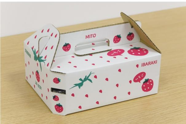
JA 水戸様の直売所での苺 2 パック用販売において、他産地にはない 6 角形状手提箱を開発した。底面はアメリカンロック形状にすることで底抜けせず、6 角形状の箱組みを容易にした。天面は持ち帰りに便利な手提げ形状を採用。角面部分の穴に、中身の苺パックの縁が掛かることにより固定され、輸送時に中身を安定させる事が実現できた。形状とデザイン提案により産地のブランド化に繋がるものとした。
