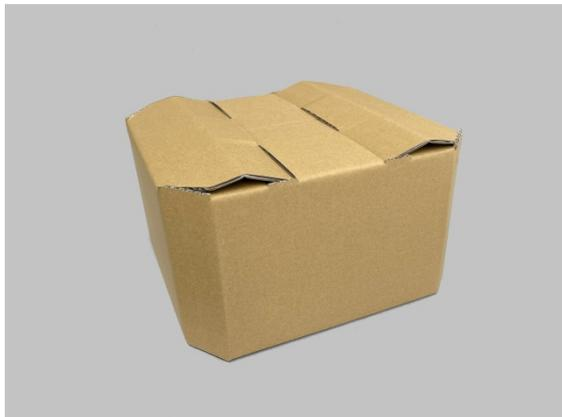
ATV(四輪バギー)用の駆動系部品の包装で、アメリカの組立工場へと輸出される。これまでもコストダウンと梱包作業改善を行ってきたが、梱包現場は深刻な人手不足の問題を抱えており、作業工数の削減は急務であり、包装仕様改善を実施すべく、新包材の開発に着手した。外装箱の八角形化、外装箱の底面のアメリカンロック部と付属仕切材を一体構造化を行った結果、箱形状の変更による箱圧縮強度向上による材質見直し、底部構造と材料ロス低減の工夫などの改善を施した。この結果、包材コスト-35%、組立工数-20%を実現した。
