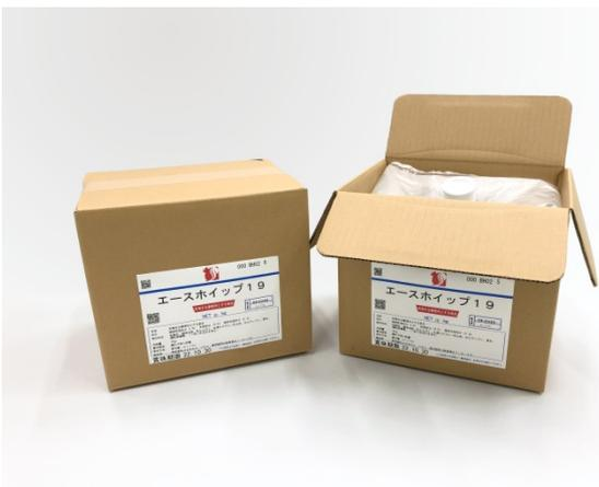
強度のある材質を使った 0201 形でもフラップの反発を抑え、テープ封緘で隙間ができない外装箱を開発した。従来、フラップの反発を抑える方法として、0201 形のフラップ罫線を段違いにし全抜き加工していたが、0201 形の製造よりも 1 工程多く、コストアップとなっていた。そこで、外フラップに円弧状の罫線を追加し、外フラップの反発力を低減させ、内フラップの罫線下にも罫線を追加し、フラップを重なりやすくした。この結果、0201 形と同じ工程で製造でき、段ボール使用量を約 6%削減、リードタイムも短縮することができた。
